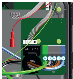
Obrázek 8b: Připojení svorek napájení a konektoru Control Pilot (CP) pro nabíjecí kabel (červený) u modelů S-line 3 fáze a Pro-line.
